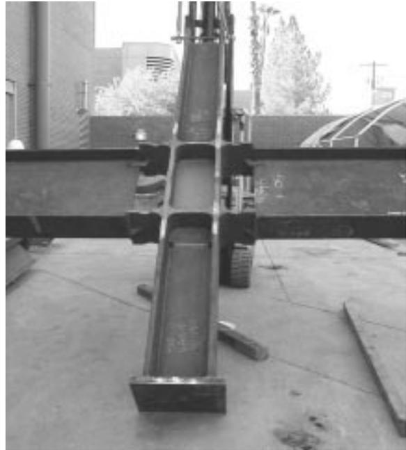
**Figure 32. PZ dissipator subassemblage.**
